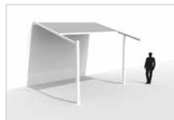
Combinatie van eindkolom en verschoven kolom is mogelijk
