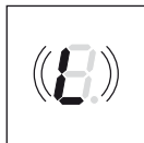
Langsames Blinken in der 7-Segment-Anzeige
